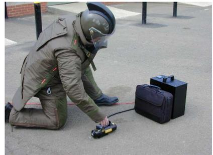
O SCANTRAK, da SCANNA MSC Ltd, é um sistema leve e portátil de visão em raios X, adequado para uma grande variedade de aplicações de detecção in loco.
